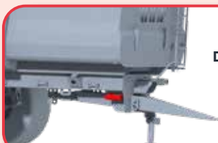
Inklapbare aluminium ladder, gegalvaniseerde zijspatborden en voorafuitrusting voor optionele uitrusting (zijbumper en thermoplastische spatborden).
