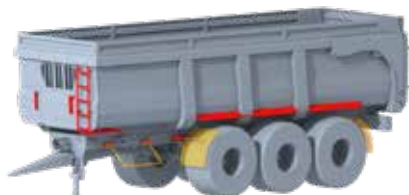
Inklapbare aluminium ladder, gegalvaniseerde zijspatborden en voorafuitrusting voor optionele uitrusting (zijbumper en thermoplastische spatborden).
