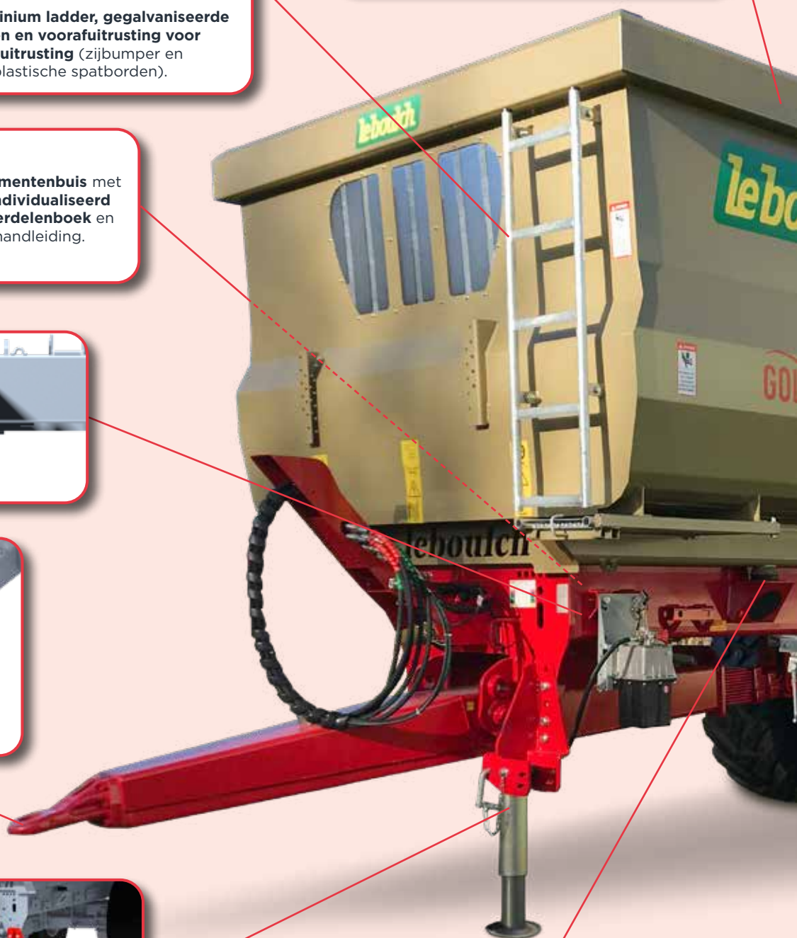
Conische laadbak (2,25 m vooraan en 2,3 m achteraan), breder onderaan dan bovenaan om het lossen te vergemakkelijken.
